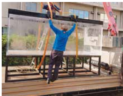
写真2. アクリル水槽を大型トラックから中型トラックに移し、標本室の近くまで移動後、クレーンで地上に降ろす
